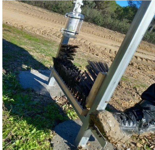
Figura 10: Estaciones de limpieza de calzado diseñadas para el proyecto FAGESOS. Las estaciones incluían cepillos laterales, placas laterales para eliminar el exceso de barro y dispensador de desinfectante.
