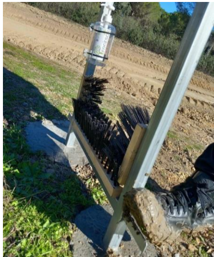
Figure 10: Estações de limpeza de calçado concebidas para o projeto FAGESOS. As estações incluíam escovas laterais, placas laterais para remover o excesso de lama e um dispensador de desinfetante.
